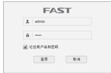
3 经过上述步骤即可成功进入交换机管理软件界面，如下图所示。点击主页左侧的主菜单栏即可进行相应功能的配置。
